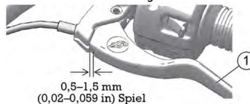
2. Das Spiel des Kupplungshebels ist der Weg des Hebels von der Ruhestellung bis zu dem Punkt, an dem der Widerstand des Kupplungszugs zu spüren ist. Das Spiel des Kupplungshebels muss zwischen 0,5 und 1,5 mm liegen. Den Spalt zwischen Kupplungshebel und Hebelgehäuse messen. Siehe Seite 91. Wenn nötig, das Spiel des Kupplungshebels nachjustieren.
