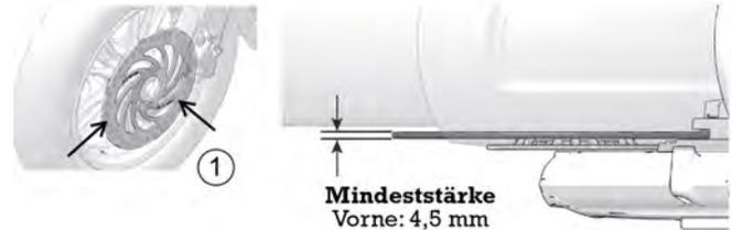
2. Wenn beim Bremsen aufgrund von Schmutz oder Staub leichte Quietschgeräusche zu hören sind, die Bremsscheiben reinigen. Bremsenreiniger auf einen sauberen Werkstattlappen geben und die Bremsscheiben abwischen. Der Bremsenreiniger darf NICHT auf Lack- oder Kunststoffflächen gelangen. Alle Sicherheitshinweise auf der Verpackung lesen.
